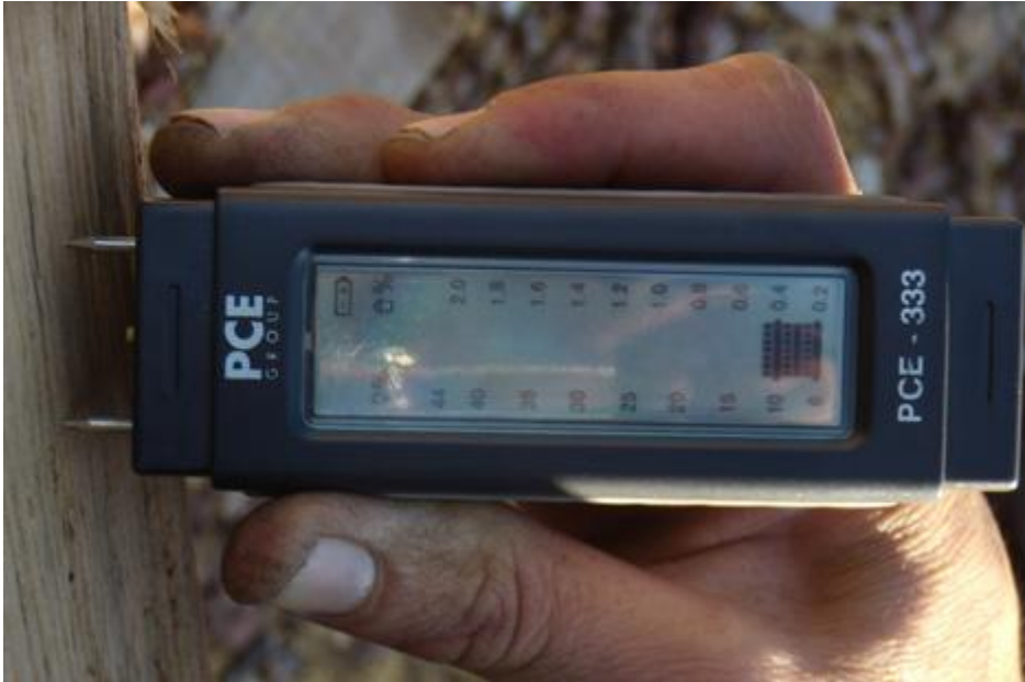
Medidor de humedad, sencillo utensilio para testar la humedad en la madera.
